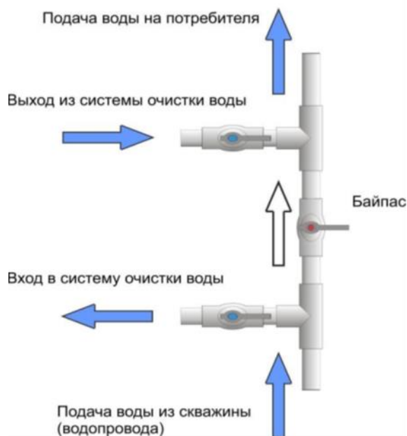
Врезка системы в трубопровод
